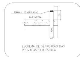
ESQUEMA DE VENTILAÇÃO DAS PRUMADAS SEM ESCALA
