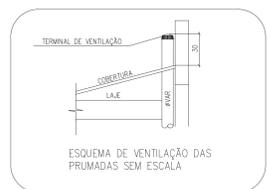
ESQUEMA DE VENTILAÇÃO DAS PRUMADAS SEM ESCALA
