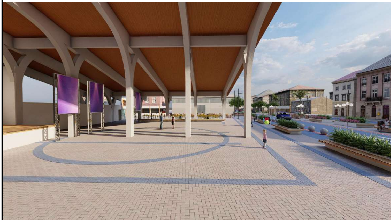
COBERTURA COM ESCRUTURA DE CONCRETO. PÁTIO COM PISO INTERTRAVADO CIMENTÍCIO E DETALHES COM PINTURA.
